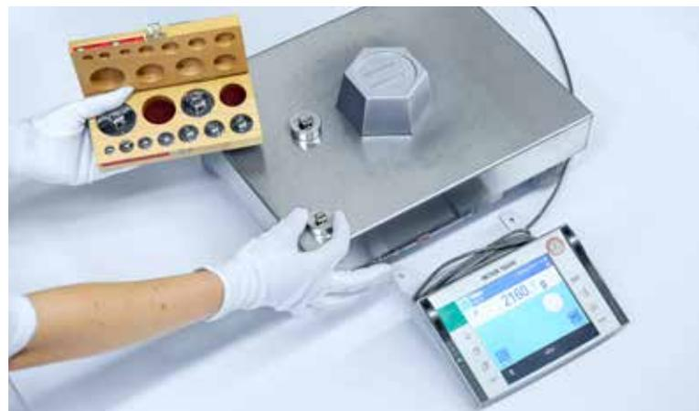
Kalibrierung der eingesetzten Waagen
