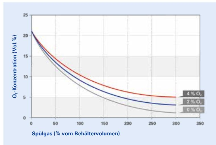
Theoretisch benötigte Spülgasmenge zur Einstellung einer gewünschten O<sub>2</sub>-Konzentration (...Rest O<sub>2</sub> im Spülgas)
